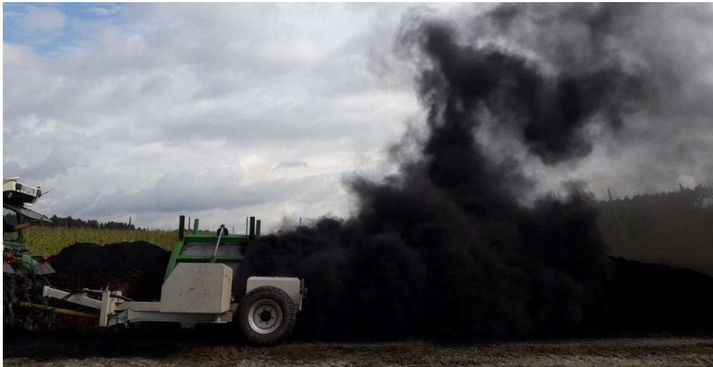
Abb. 2: Starke Staubentwicklung beim Aufsetzen einer Kompostmiete mit einer zu trockenen Pflanzenkohle
