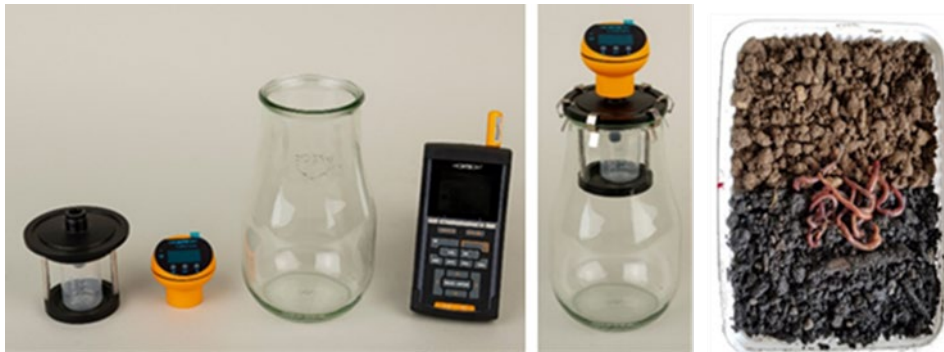
Abb. 10: OxiTop-Messsystem zur Bestimmung der mikrobiellen Aktivität (links) sowie Prüfgefäß für den Regenwurmvermeidungstest mit einem Prüf- und einem Kontrollboden sowie den eingesetzten Regenwürmern (rechts)
