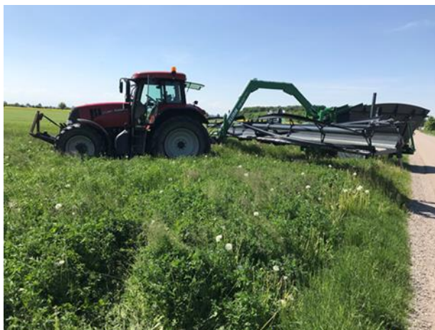
Abbildung 1: Erntemaschine "Top Cut Collect" zur Ernte von Luzernespitzen (© R. Rößner)
