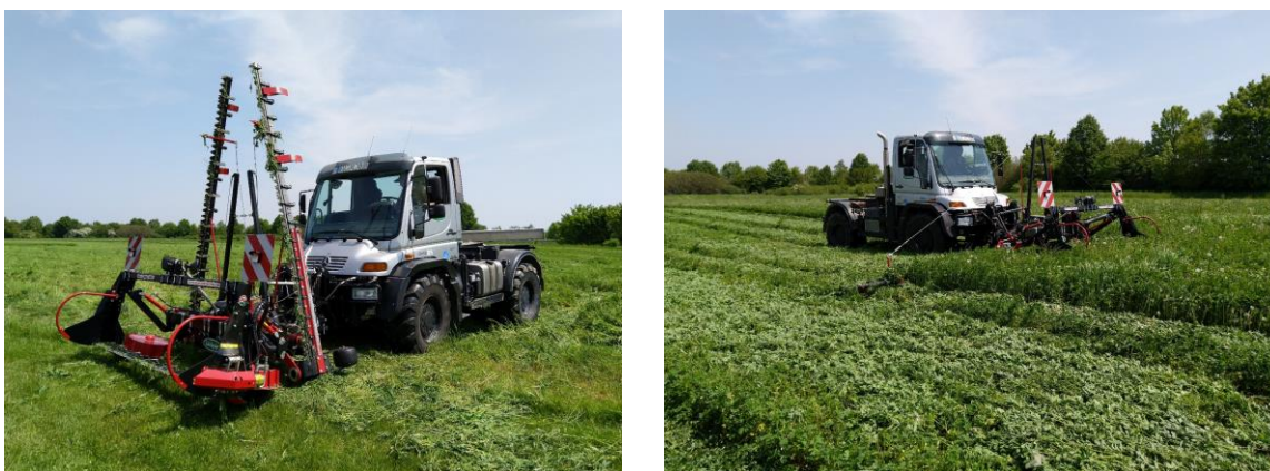
Abbildung 4: Doppelmessermähkombination der Firma BB Umwelttechnik zur Ernte von Luzernespitzen im Transportzustand (links) und während des Mähens (rechts) (© J. Maxa)
