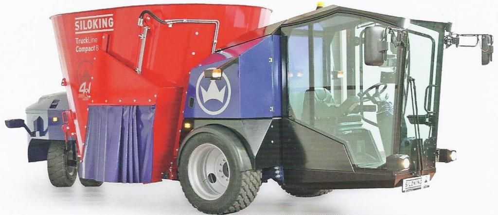
SILOKING **TruckLine 4.0 Compact 8** ist ein 100 % elektrisch angetriebener selbstfahrender Futtermischwagen mit einem Beladevolumen von 8 m<sup>3</sup>. Der **TruckLine** dient zum Mischen, Transportieren und Ausdosieren von Futter.
