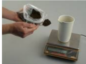
2. gesiebten Boden abwiegen
