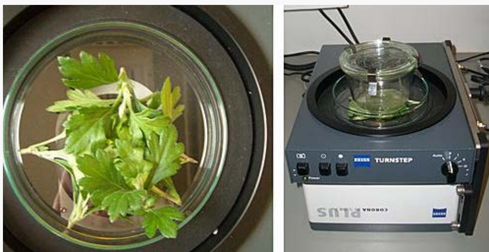
Abb. 2: Auflegen der Stecklinge auf dem Turnstep und Durchführung der Messung
