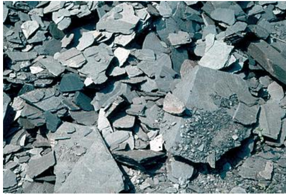
Abb. 2: Tonschiefer, Ausgangsmaterial für die Herstellung von Blähschiefer (Quelle: FGW)
