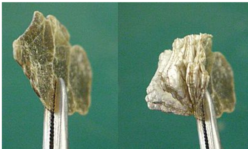
Abb. 1: Roh-Vermiculit-Plättchen (links) und durch Erhitzen exfoliertes Material
