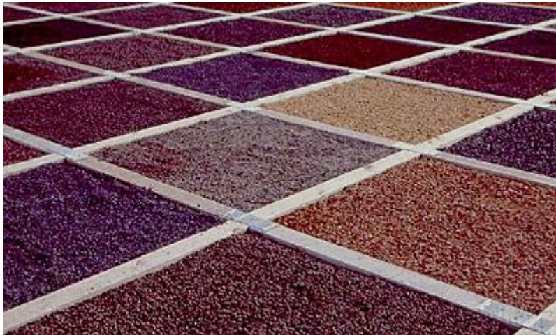
Abb. 2: Versuchsanlage mit unterschiedlichen (mineralischen) Substraten für eine extensive Dachbegrünung
