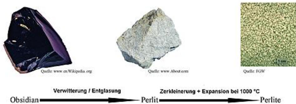
Abb. 2: Vom Ausgangsgestein Obsidian bis zum Endprodukt Perlite
