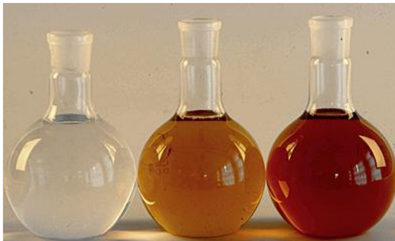
Abb. 3: Färbung des Drainwassers bei unterschiedlichen Dachbegrünungssubstraten (li. Porlith; mitte: Lava/Bims; re. gebrochener Blähschiefer - jeweils mit 10 Vol.-% Rindenumus)
