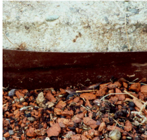
Abb. 3: Sackung durch Volumen- und Masseverlust bei einer Mischung aus 30 Vol.-% Kompost, 20 Vol.-% Holzfasern und 50 Vol.-% Ziegelbruch nach 2 Jahren
