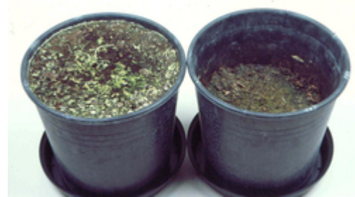
Sackung durch Volumen- und Masseverlust nach ca. 6 Monaten bei einem Torfsubstrat (li.) und einer Mischung aus 30 Vol.-% Kompost und 70 Vol.-% Holzfaser (re.)
