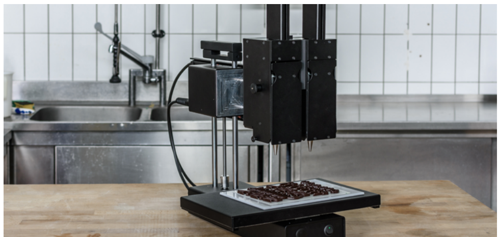
Abbildung 34: Weltweit erstes Mehrkopf 3D Food Printing System, mit dem bereits verschiedenste Lebensmittel erfolgreich aus mehreren Komponenten hergestellt werden konnten
