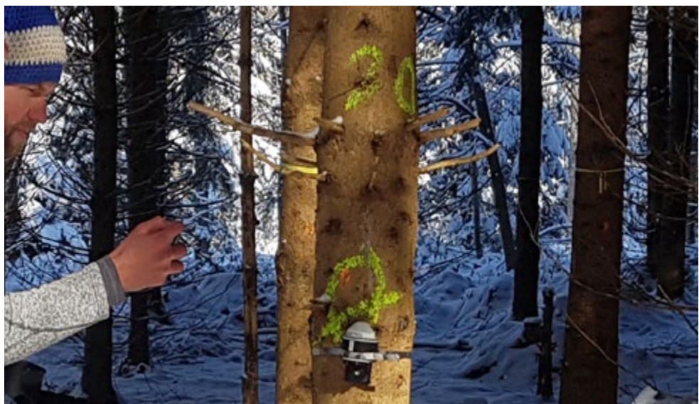
Elektronisches Dendrometer zur laufenden Erfassung des Brusthöhendurchmessers an einem Grundflächenmittelstamm in einem Fichtenbestand im Westerholz bei Kaufering.
